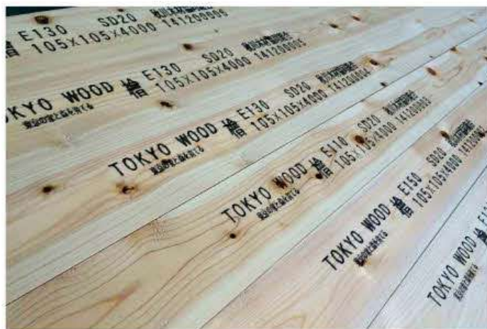
グレーディングマシンによって品質検査を終えた TOKYO WOOD (E-硬度 /SD-含水率)
